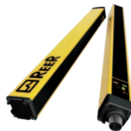
Bezpečnostní světelné závory kategorie 4, SIL 3 – SIL CL3, PL e profil 28 x 30 mm, ochranné pole: 160–2 260 mm
